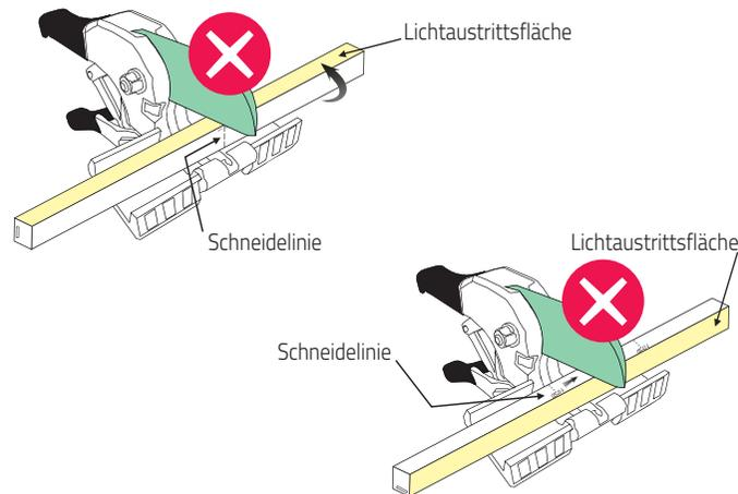
Es darf nur entlang der abgedruckten Schnittlinien geschnitten werden, und nicht zwischen den Markierungen.
