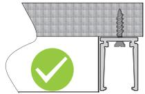
Verschrauben Sie das Profil mit dem Montageuntergrund und stellen Sie sicher, dass die Schraube bündig oder tiefer als die Montagelinie liegt.
