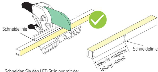
Schneiden Sie den LED Strip nur mit der gedruckten Schneidelinie oben liegend.
