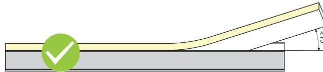
Der Installationswinkel muss kleiner als  $15^\circ$  sein, während das Band per Hand in das Profil gedrückt wird.
