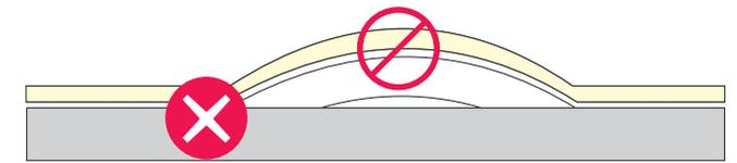
Der LED-Strip ist aus einer Installationsrichtung zu verarbeiten, um einen Materialüberschuss zu verhindern.
