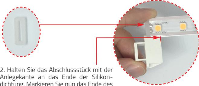
2. Halten Sie das Abschlussstück mit der Anlegekante an das Ende der Silikondichtung. Markieren Sie nun das Ende des Abschlussstücks mit einem Stift auf dem VARDIFLEX AC Eco.
